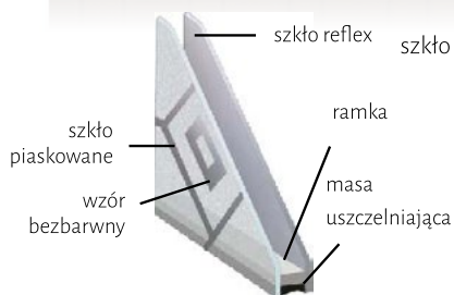
Zespolony pakiet szklany jednokomorowy SZKŁO PIASKOWANE/ REFLEX
