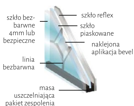
Zespolony pakiet szklany dwukomorowy FLOAT/ SZKŁO PIASKOWANE + BEVEL/ REFLEX
