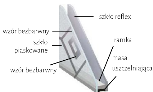
Zespolony pakiet szklany jednokomorowy SZKŁO PIASKOWANE/ REFLEX
