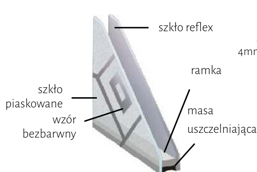
Zespolony pakiet szklany jednokomorowy SZKŁO PIASKOWANE/ REFLEX
