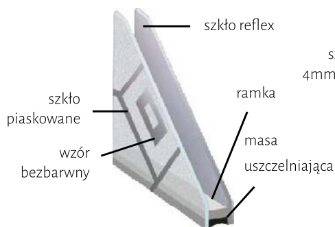
Zespolony pakiet szklany jednokomorowy SZKŁO PIASKOWANE/ REFLEX
