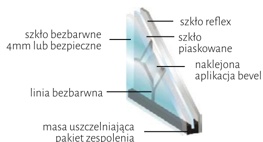
Zespolony pakiet szklany dwukomorowy FLOAT/ SZKŁO PIASKOWANE + FUSING/ REFLEX
