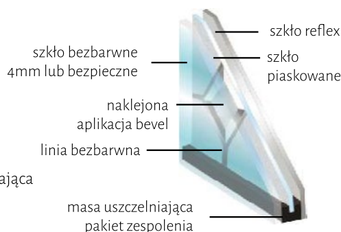
Zespolony pakiet szklany dwukomorowy FLOAT/ SZKŁO PIASKOWANE + BEVEL/ REFLEX
